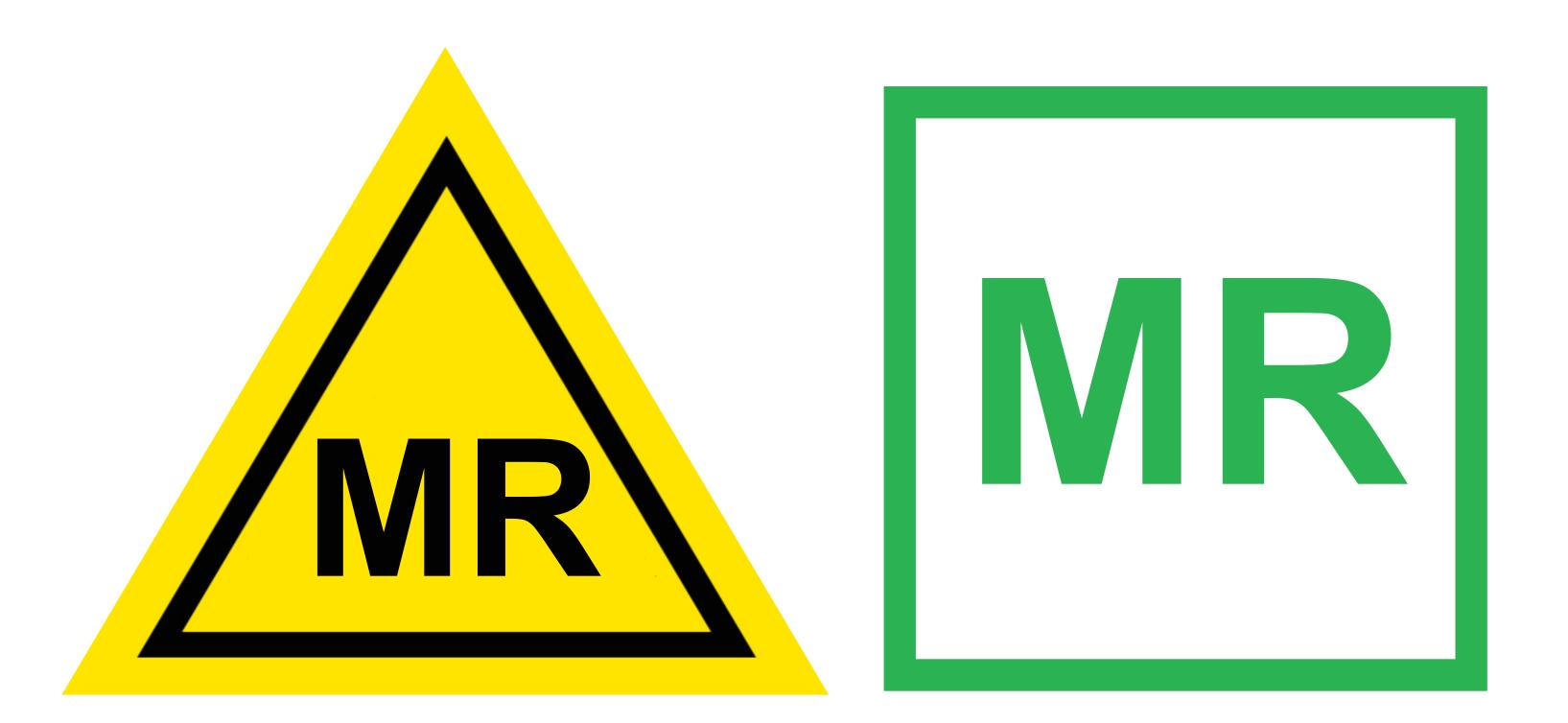
筛查以确保所有进入磁共振扫描室的装置或物品是条件性磁共振 兼容的(MR Conditional)或是磁共振安全的(MR Safe)。条件性磁共 振兼容装置的安全扫描条件需和磁共振仪器的扫描条件吻合。所 有的金属, 甚至非铁磁性的, 都有可能发热并造成灼伤。
